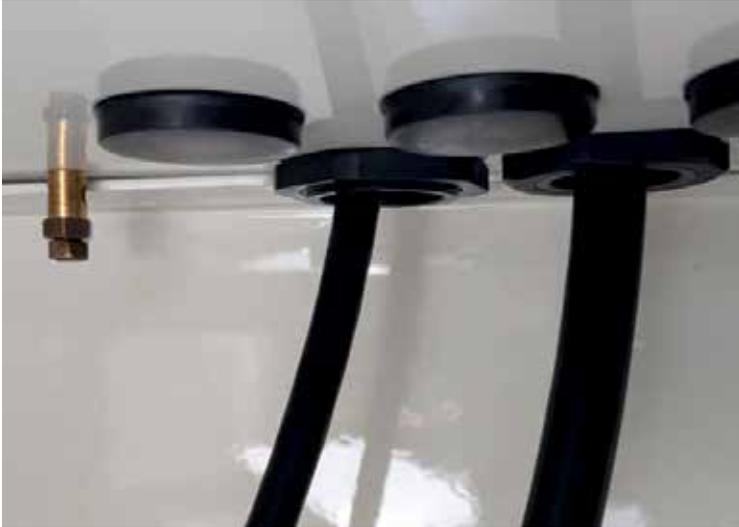
8. Pase el cable por el conjunto del prensaestopas y apriételo hasta que el ojal encaje completamente en el cable.
