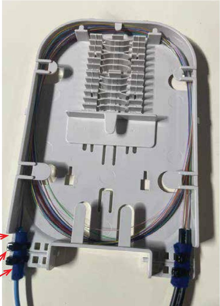
Retire el tubo amortiguador y asegúrelo a la bandeja
