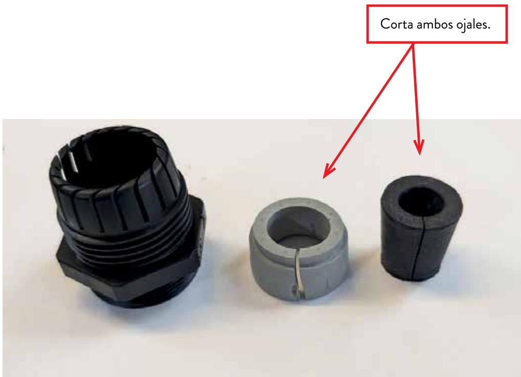
3. Pase con cuidado los conectores a través de la tuerca selladora del cable inferior y luego deslícelos sobre el resto del conjunto de cables, más allá de la bifurcación.
