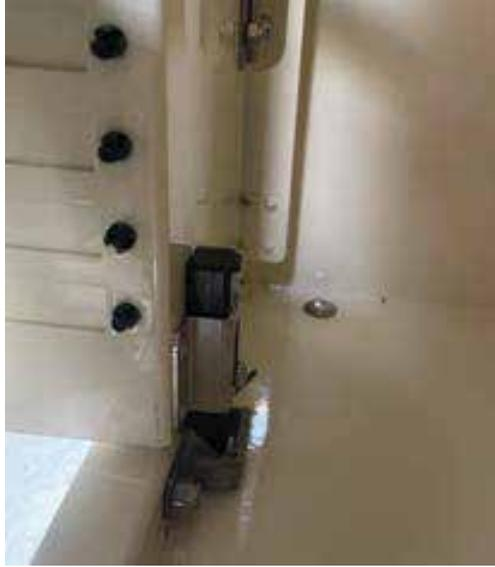
2. Asegure el panel abatible con el sujetador del panel abatible.
